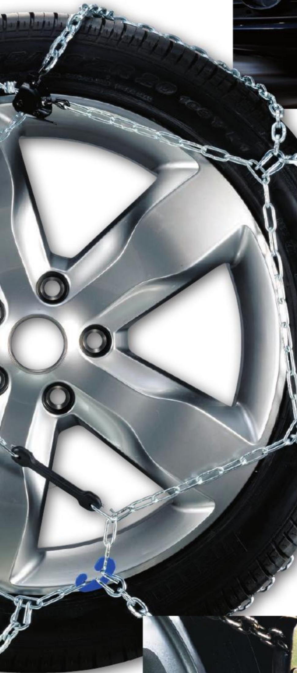
*Nella catena XS9 i ganci in materiale plastico disposti lungo la catena laterale consentono di alloggiare lontano dal cerchio in lega il catenino di tensione del dispositivo di chiusura della catena.*
