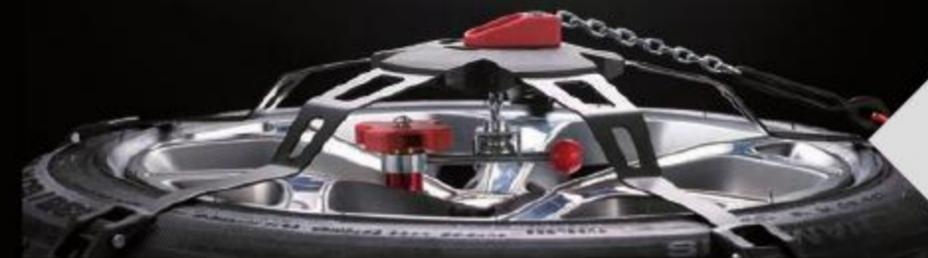
*Mediante l'azione combinata di una spinta trasversale alla gomma, generata dalle braccia e della forza centrifuga applicata al pneumatico in rotazione, la catena si dispone automaticamente nella posizione più corretta.*
