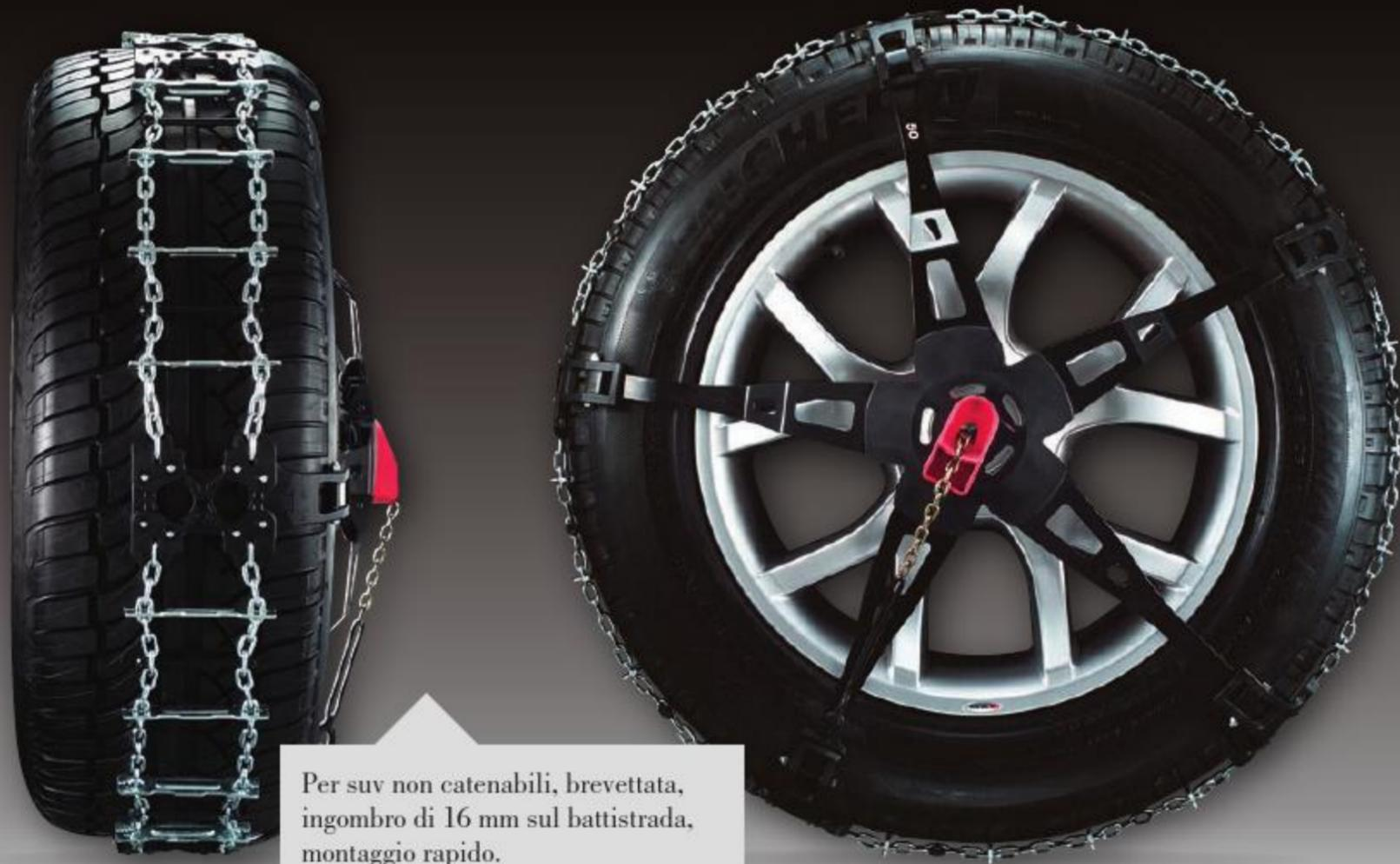
Per SUV non catenabili, brevettata, ingombro di 16 mm sul battistrada, montaggio rapido.
