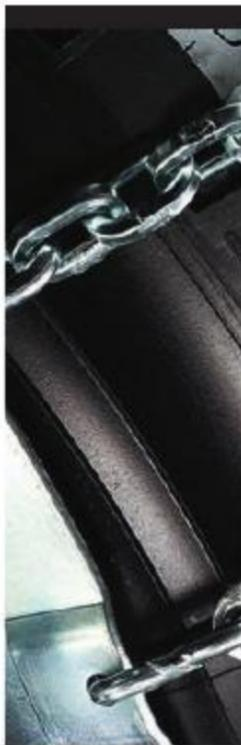
*Molle in acciaio e ganci robusti vengono utilizzati per le chiusure delle catene da neve Maggigroup®, tutte rigorosamente a maglia d'acciaio in sezione mezza quadra per conferire miglior tenuta e resistenza all'abrasione.*
