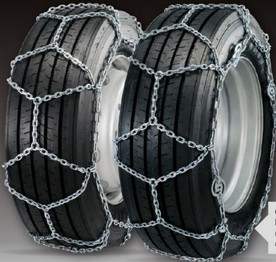
Catena da camion con gruppi romboidali tipo Select ma con tensionamento multiplo laterale per mezzo di quattro dischi tensionatori.
